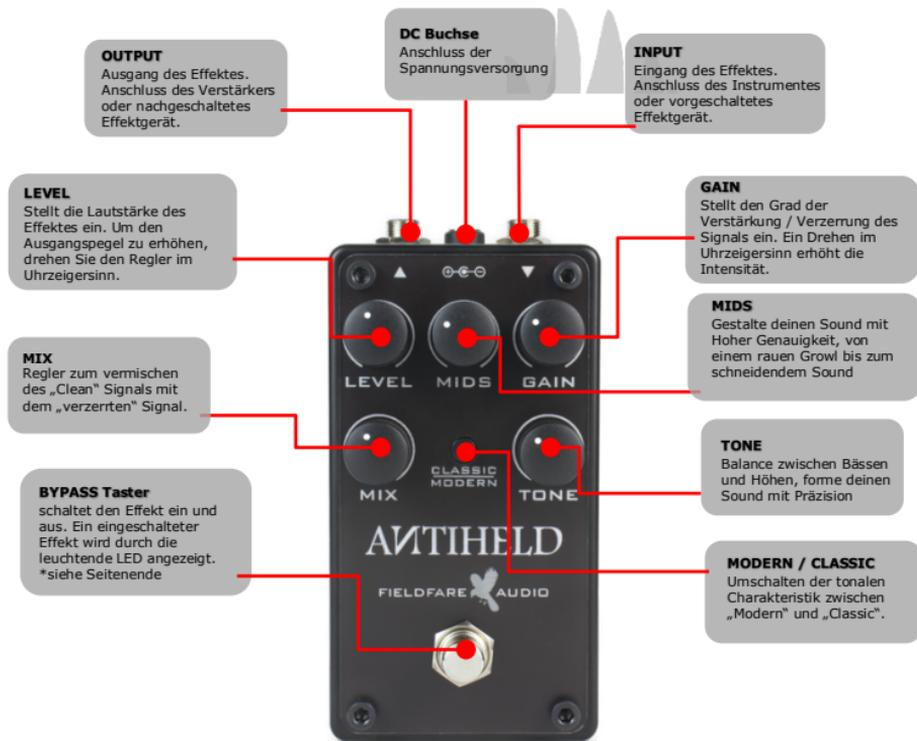
Der relaisbasierte intelligente True Bypass verfügt über eine "Momentary"-Funktion. Das Pedal wird beim längeren Drücken des Fußtasters nur für die Dauer des Drückens aktiviert / deaktiviert.
